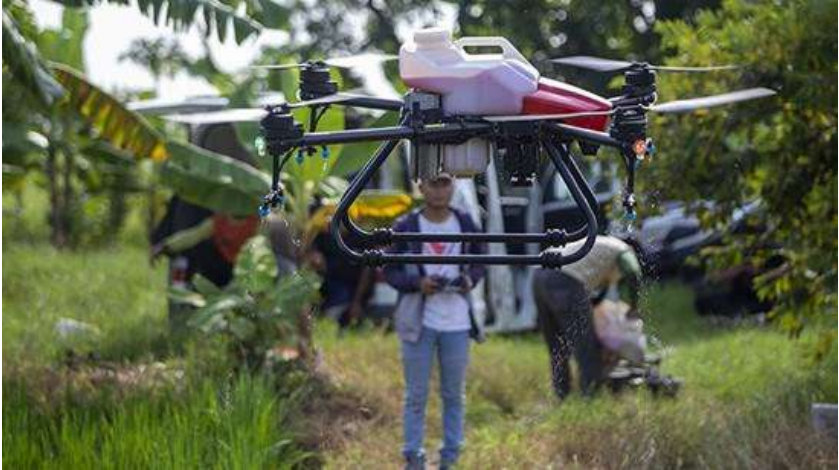
Gambar 1.6 Drone Sprayer, Penyemprotan pestisida dilahan sawah desa tegalurung, Blangon, Indramayu, Jawa Barat. Sebahagian petani sudah mulai menggunakan dron untuk menyemprot pestisida dengan biaya 5 jt perhektar untuk delapan kali penyemprotan selama satu kali musim tanam (Bestari, 2024).
